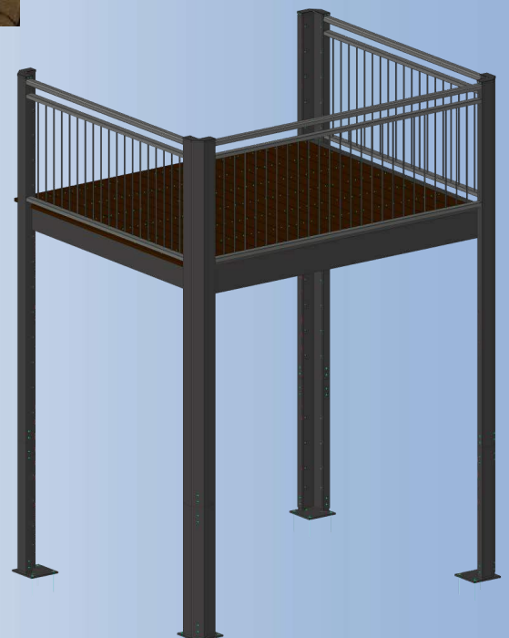
Beispiel: Balkon mit Stabgeländer
