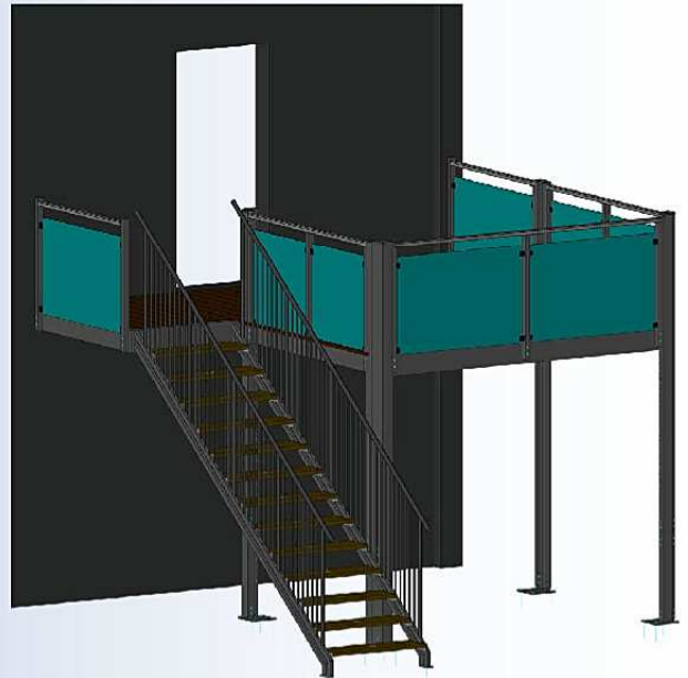
Balkonmodell mit Aufgangstreppe und Glaselementen
